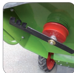
Gekapseltes Messerlager für optimalen Schutz gegen Beschädigung
